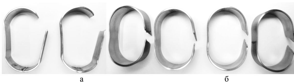
Рис. 3. Кільцеві зразки після випробування на розтягування:
